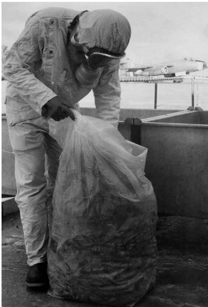
Mise en sac des déchets radioactifs avant mise en fût sur l'aire de décontamination des Vautour (Photo JP Ambroise)
