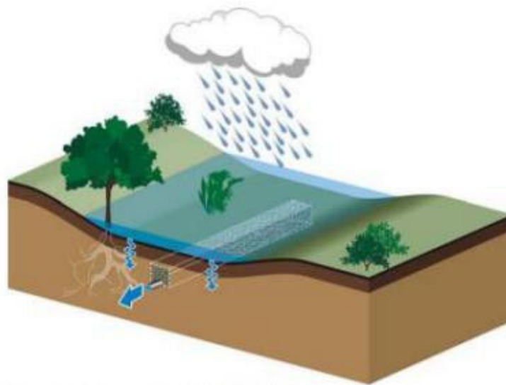
Figure 2 - Fonctionnement de principe de la noue drainante/infiltrante
