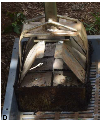
Démoulage des mottes
