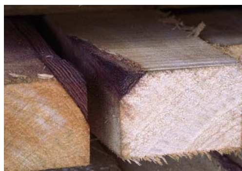
8. Flache = présence d'écorce ou manque de bois, quelle qu'en soit la cause, sur l'arête d'une pièce de bois.
