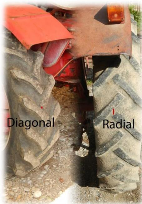
Figure 2: Différence radial/diagonal
