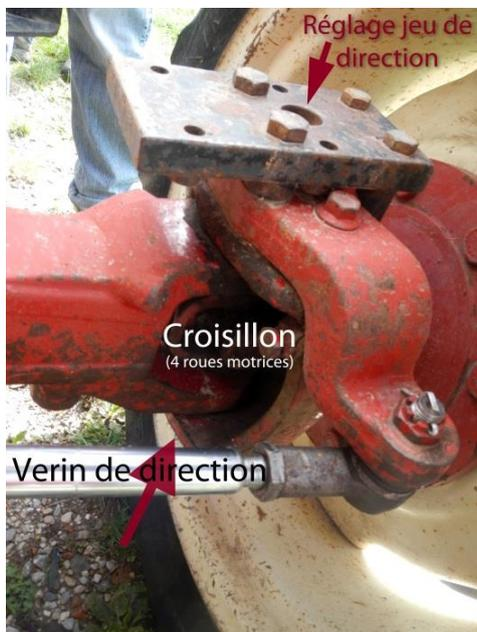
**Jeu de pivot de direction :** Pour ce réglage, il faut lever le pont avant à l'aide d'un cric pour pouvoir apprécier le jeu du pivot (vertical) de direction. Pour la même raison que pour le roulement de roue, rattraper le jeu mais ne pas serrer exagérément.
