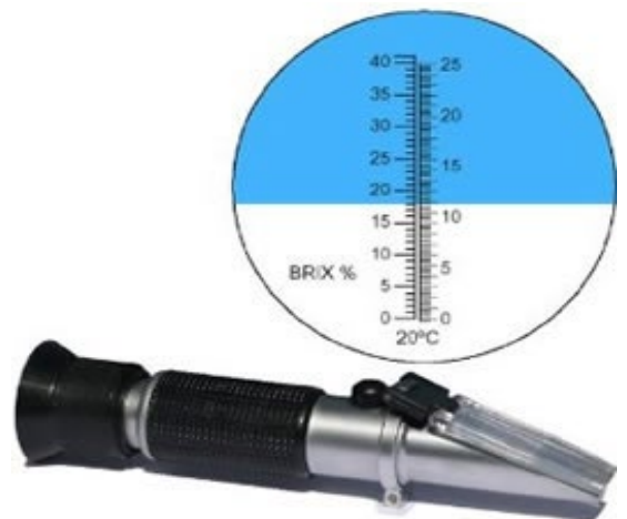
Figure 1: le réfractomètre, un outil indispensable pour une production régulière.
