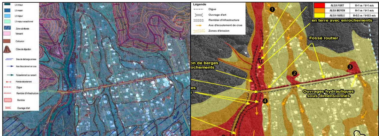
Fig. 5 Tronçon 2 : hydrogéomorphologie et qualification des aléas
