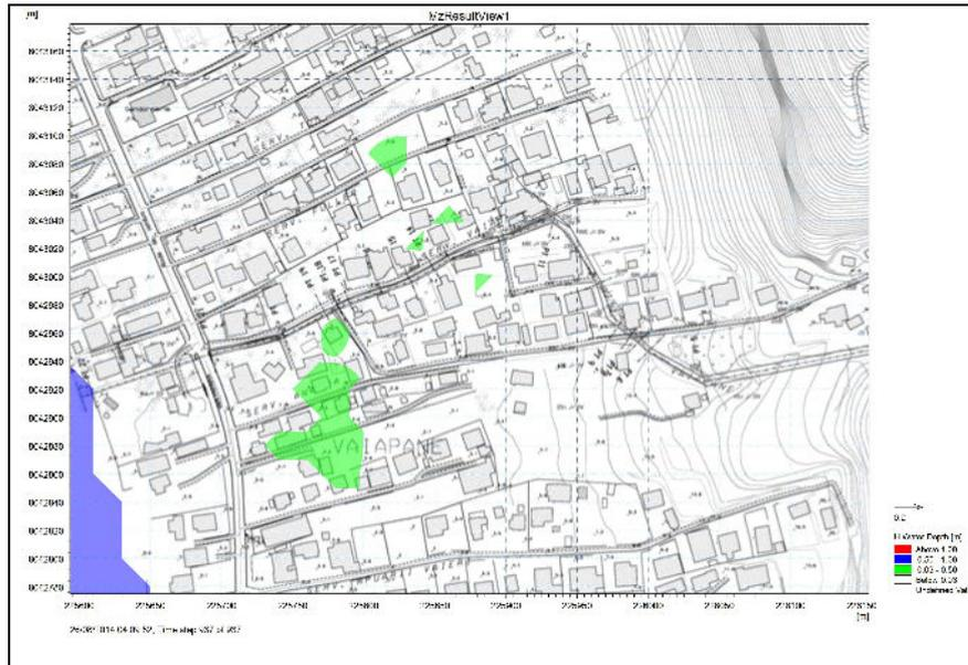
Figure 11 : Hauteur d'eau dans le lit majeur à la fin de la simulation (4h10 après le début de la crue décennale)
