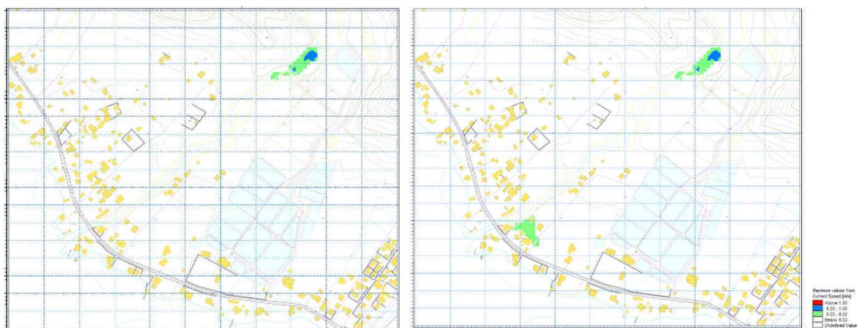
Figure 12. Modélisation 2D des vitesses d'écoulements maximales en crue décennale sans (à gauche) et avec érosion des digues (à droite).
