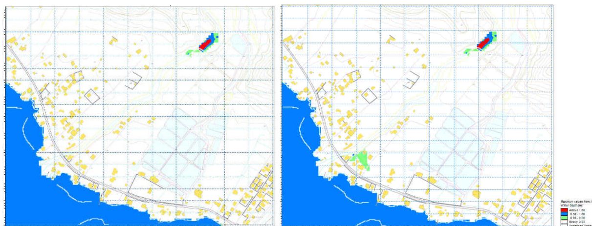
Figure 11. Modélisation 2D des hauteurs d'eau maximales en crue décennale sans (à gauche) et avec érosion des digues (à droite).
