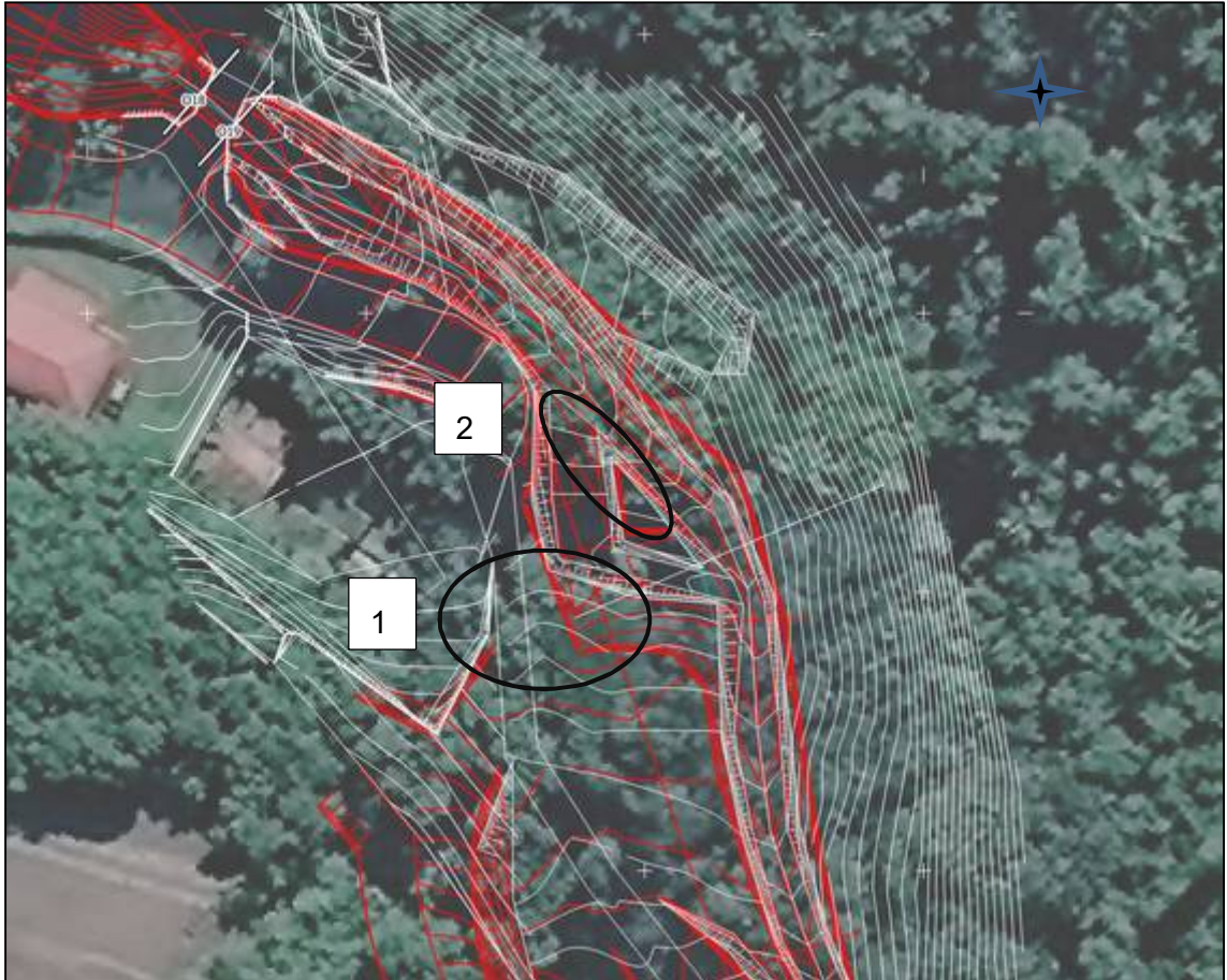
Figure 1-32 : Comparaison topographies 2015 et 2019 – Zone A
