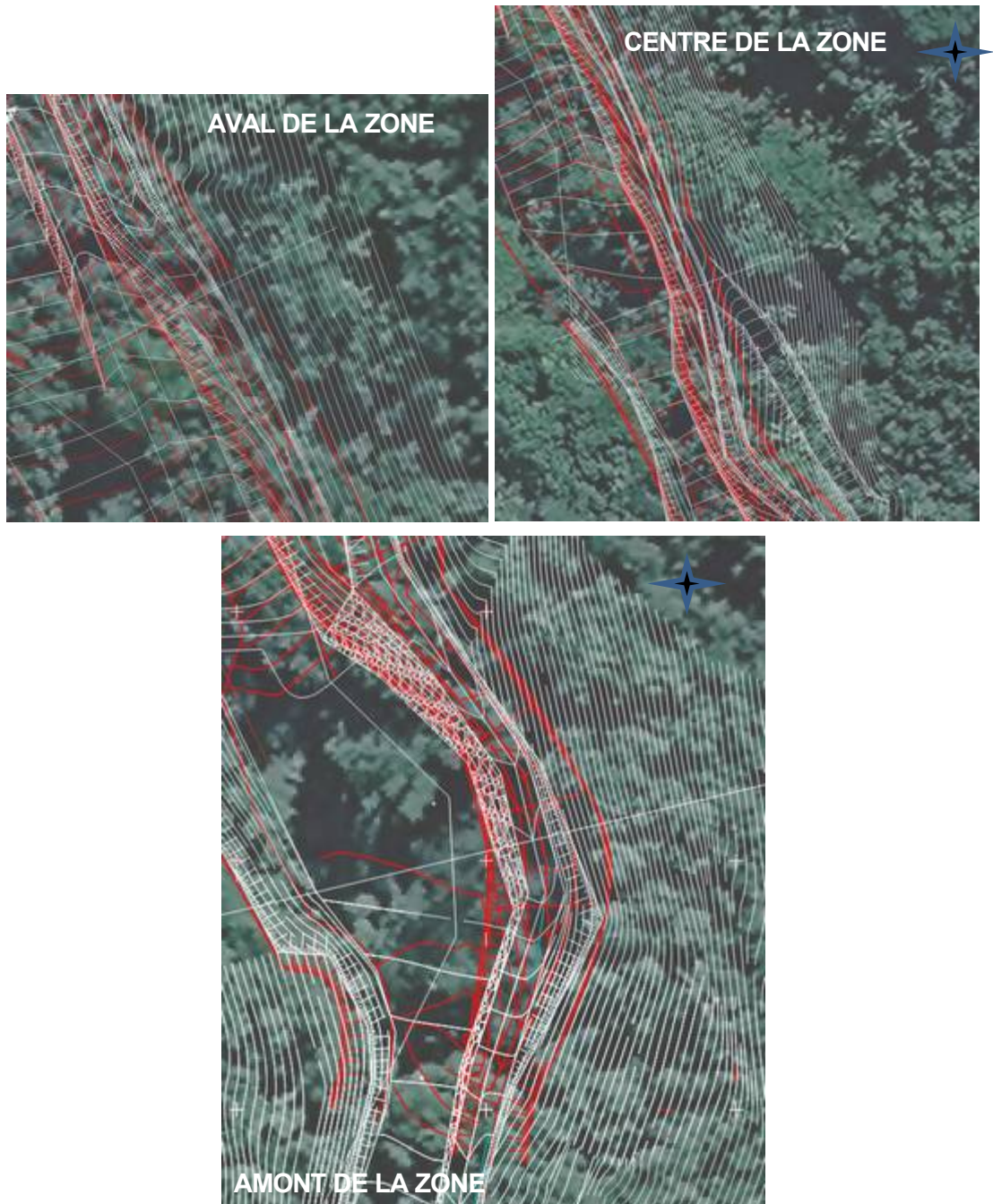
Figure 1-33 : Comparaison topographies 2015 et 2019 – Zone B
