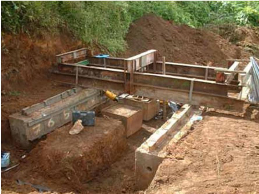
*Illustration 35 – Vue d'ensemble du dispositif d'essai de cisaillement en grand*
