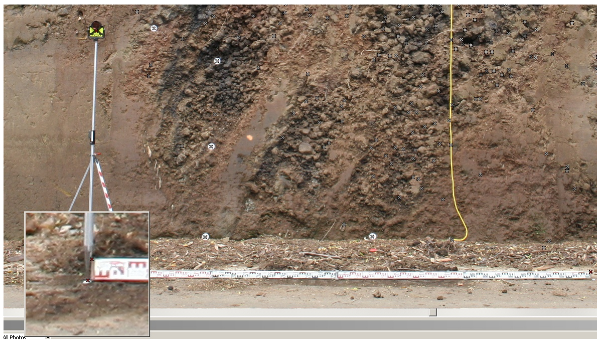
Figure 39 : Points marqués sur la mire et sur la cane pour identifier respectivement une échelle (longueur de la mire : 4 m), une direction horizontale (ici E-W) et la verticale.
