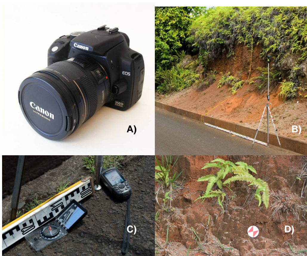
Figure 12 : Matériel mis en œuvre pour mesurer la morphologie des talus. A) Réflexe numérique Canon 350D équipé d'un objectif Canon 20 mm f/2.8. Équipement topographique : B) trépied, cane, corde graduée ; C) mire de nivellement et D) cibles servant de points de liaison entre photos.
