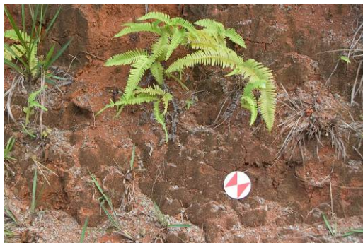
Figure 13 : Exemple de cible permettant de repérer précisément des points homologues entre points de vue différents.
