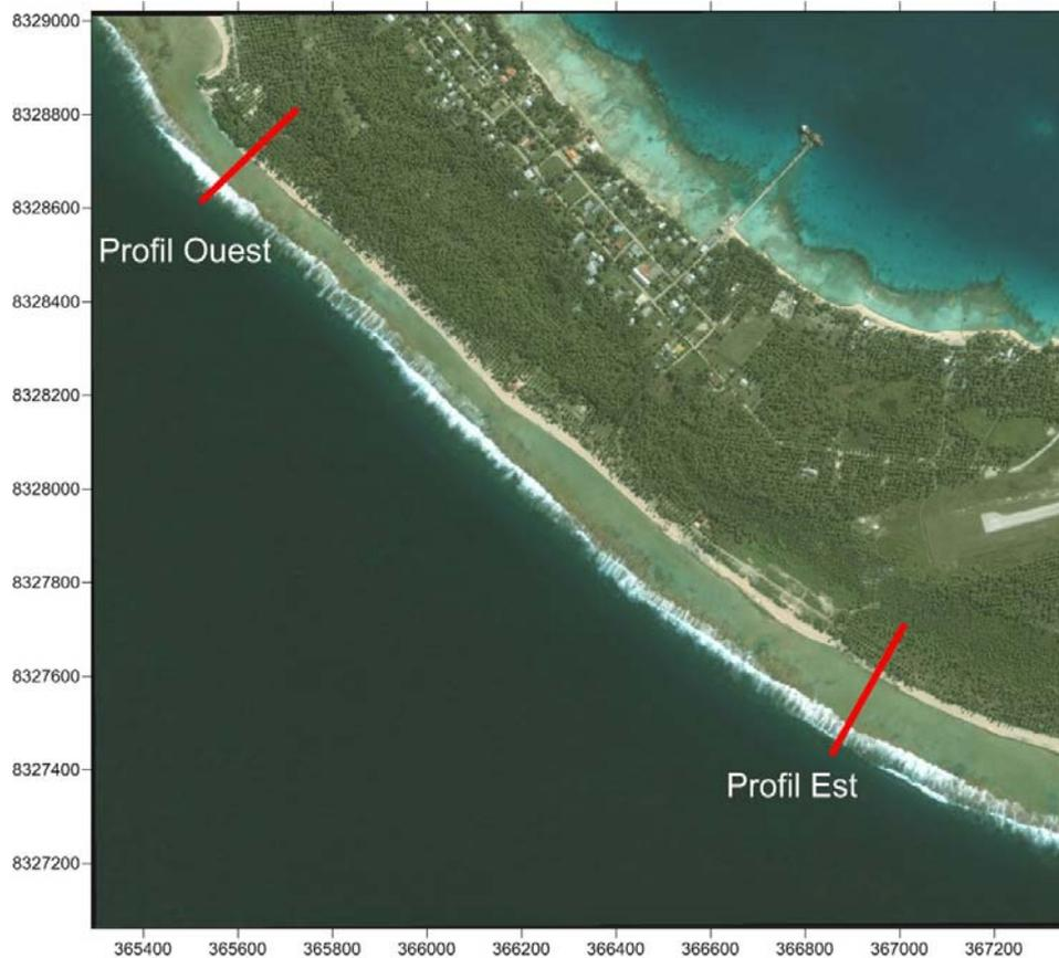
Figure 8 - Profils réalisés pour les simulations d'inondation cyclonique de l'atoll de Tikehau.
