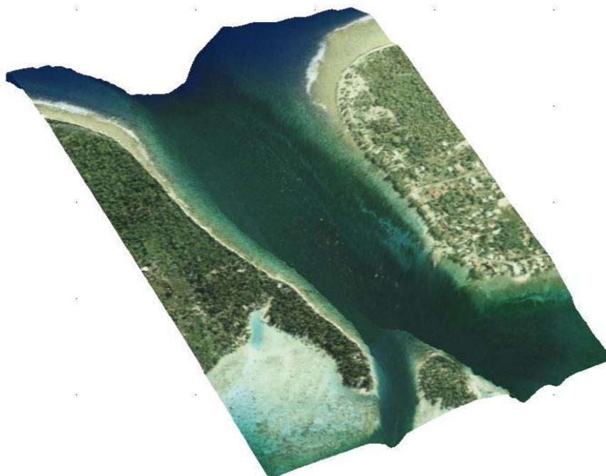
Figure 4 - MNT de la passe d'Avatoru avec un maillage 10 m \* 10 m.
