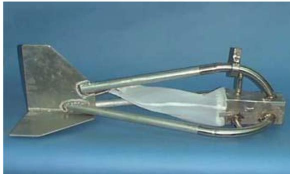
Figure 44 - Exemple d'échantillonneur Helley-Smith (US BL-84 bedload sample utilisé dans le cadre du Federal Interagency Sedimentation Project).
