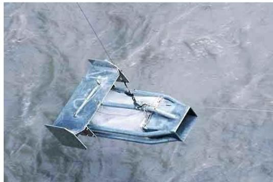
Figure 46 - Exemple d'échantillonneur dit « Toutle » (proposé par la Rickly Hydrological Company), fonctionnant suivant le même principe que les échantillonneurs Helley-Smith.
