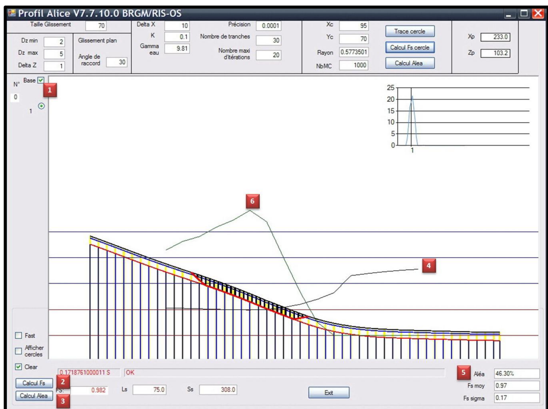
Figure 30 : fenêtre Profil ALICE® - calcul le long du profil. L'axe vertical est gradué de manière non linéaire. En partant du bas, les lignes horizontales correspondre resp. à FS=0,1, 2, 10, 100.
