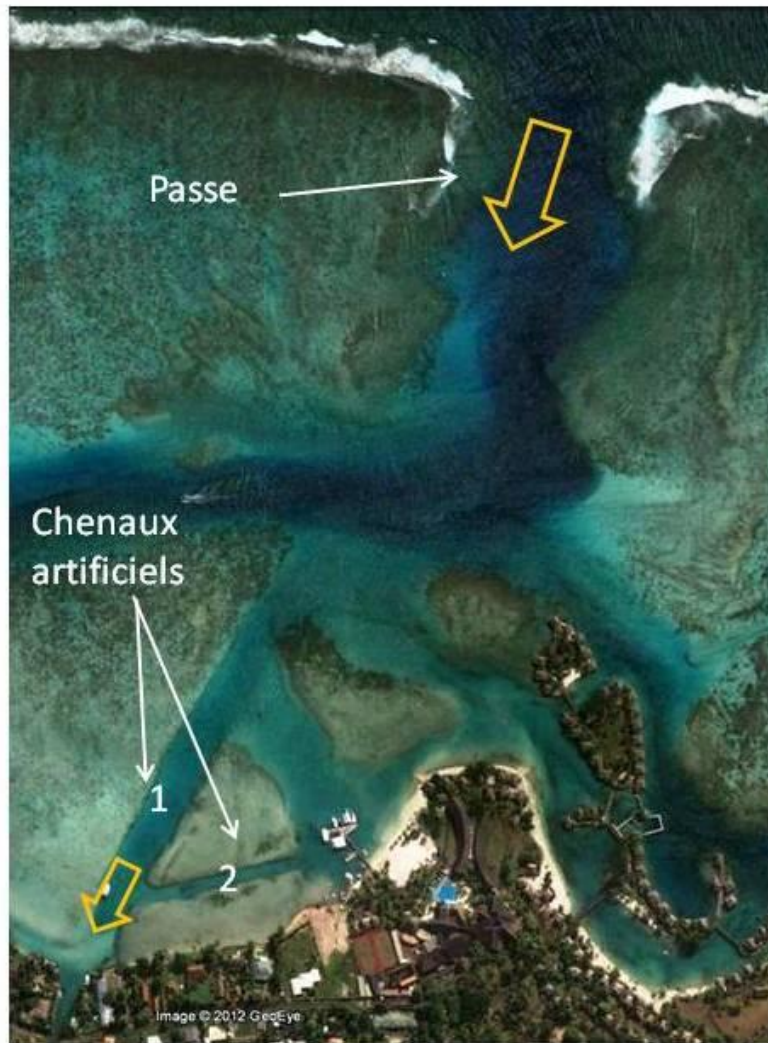
Figure 10 : Création de chenaux par dragage pouvant favoriser localement la propagation de la houle vers la côte (flèches orange, chenal 1) ou pouvant interrompre les processus de transfert sédimentaire cross-shore (chenal 2, Moorea, Image GeoEye 2012)
