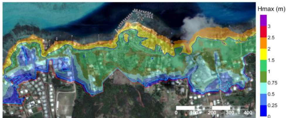
Figure 53. Résultats du modèle SWASH (actuel) : Hauteur d'eau maximale : Les traits représentent les isocontours topographiques par rapport au 0 IGN : bleu foncé : 0.6m / bleu clair : 1.8m / rouge : 2m. L'échelle est indiquée en mètres
