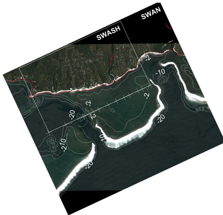
Figure 59. Emprise des modèles SWAN et SWASH. Le trait rouge indique l'isobathe 0m et les traits blancs les isobathes -20m, -10m et -2m. Les zones principales de déferlement calculées par SWAN ( 0.5 < Q_b < 1 ) sont indiquées en blanc.
