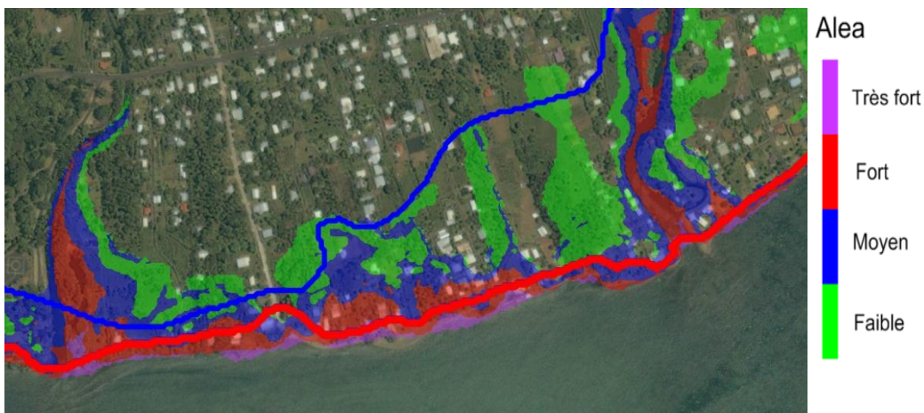
Figure 77. Extrait de la carte d'aléa submersion ARAI3 (2100) pour le site de Teva I Uta. Les contours rouge et bleu représentent les limites des zones d'aléa fort (submersion + impact des vagues) et moyen dans la cartographie d'ARA11.
