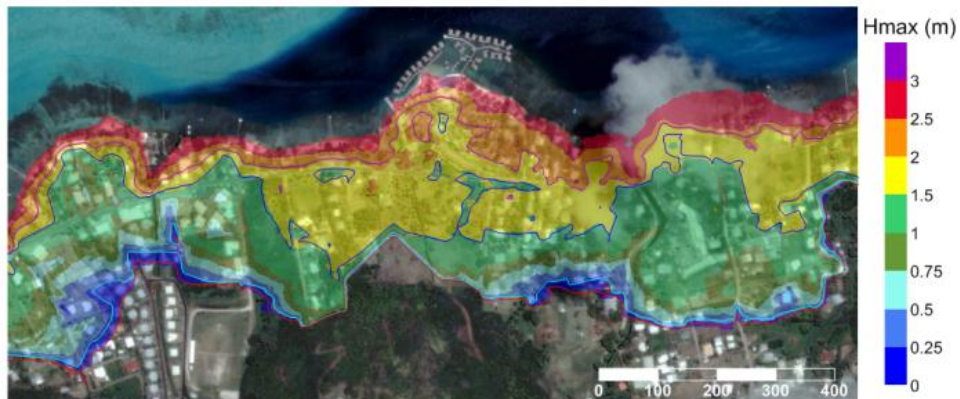
Figure 56. Résultats du modèle SWASH (2100) : Hauteur d'eau maximale : Les traits représentent les isocontours topographiques par rapport au 0 IGN : violet : 0.6m / bleu foncé : 1.1m / bleu clair : 2.3m / rouge : 2.5m. L'échelle est indiquée en mètres
