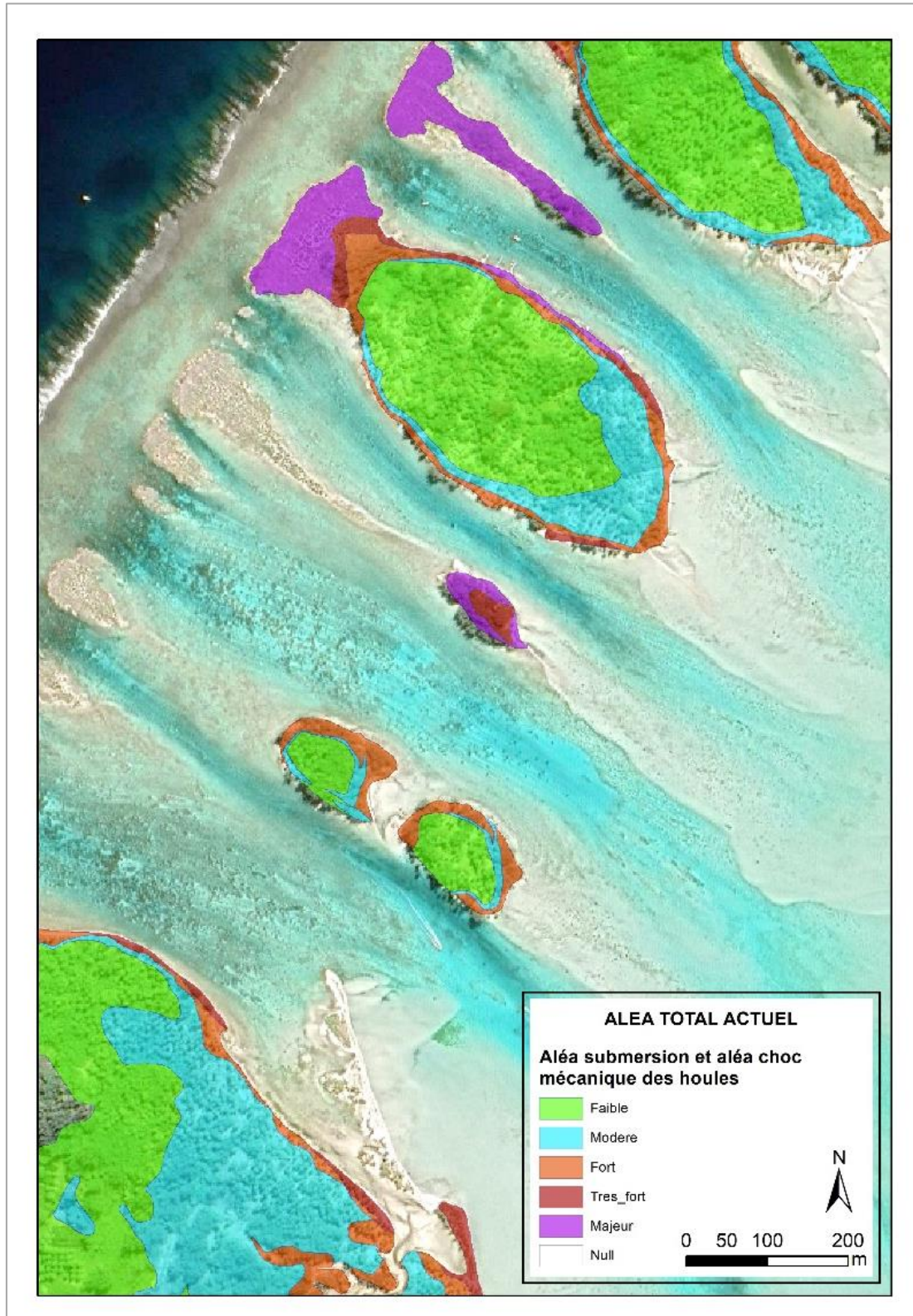
Figure 22 : Aléa total correspondant à l'aléa le plus défavorable entre l'aléa submersion marine et la bande forte de l'aléa action mécanique des houles – Exemple des motus de Bora-Bora pour l'évènement de référence B06 pour le scénario actuel
