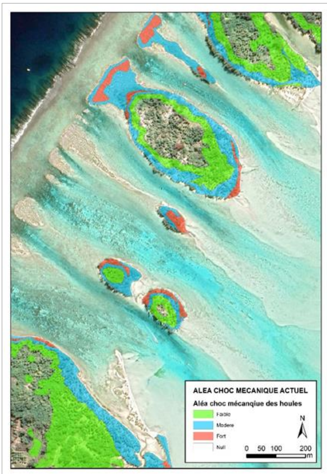
Figure 20 : Aléa choc mécanique des vagues – Exemple des motus de Bora-Bora pour l'évènement de référence B06 pour le scénario actuel
