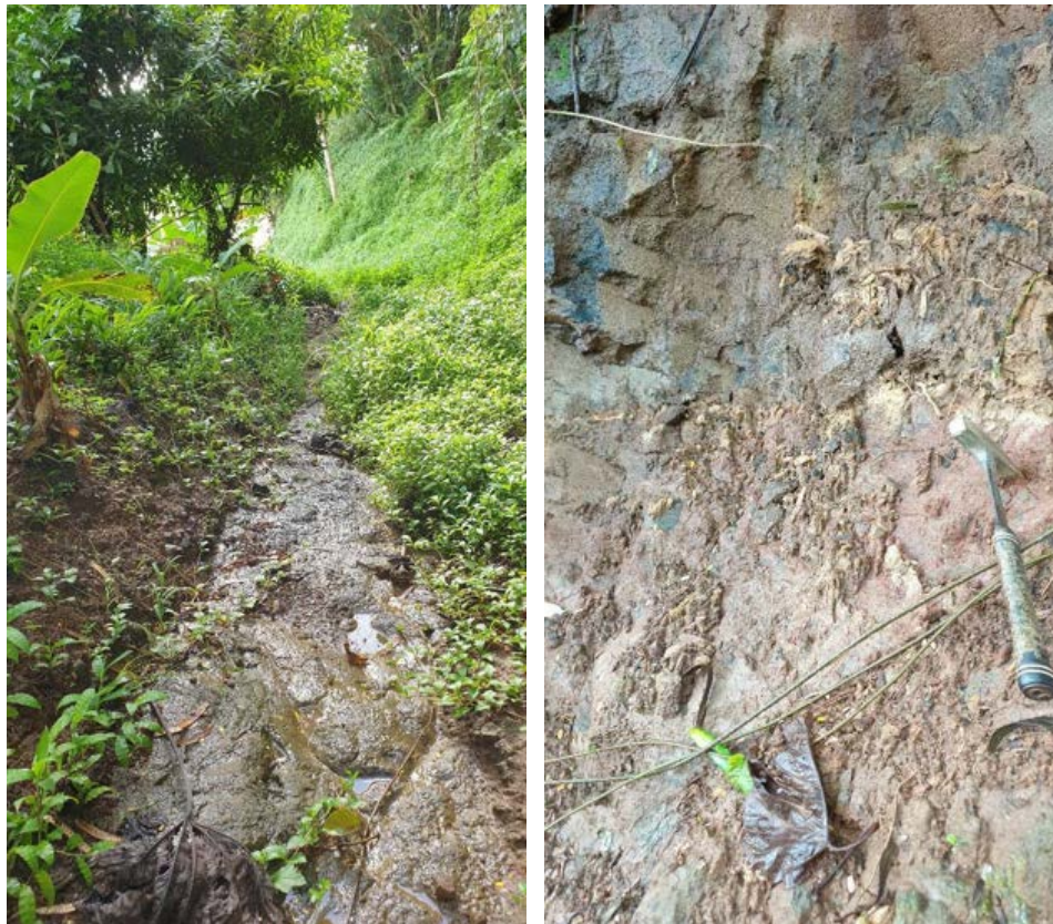
Figure 3 : Affleurement de basalte (à gauche) et de mamu de type III (à droite) (photo associée au point GPS n° 415).
