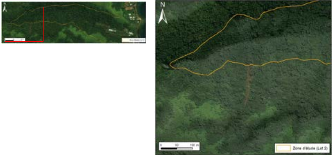
Figure 3 : Glissement observé sur les images satellites 2007 survenue au niveau du versant Sud dans la partie amont de la vallée. L'image de droite est un agrandissement de l'encadré rouge sur l'image de gauche. La distance horizontale minimale parcourue par les masses glissées est de 130 m pour un dénivelé de 170 m.
