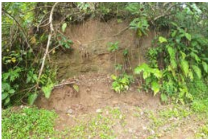
Figure 1 : Exemple de glissement récent répertorié dans la BD_MVT. La cicatrice de glissement met à l'affleurement le faciès de mamu IV au sommet et de mamu II à la base (photo associée au point GPS n° 257).
