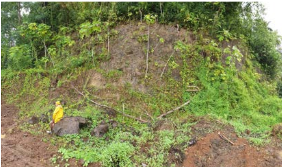
Figure 4 : Eboulement d'environ 10 m 3 avec des blocs d'un volume individuel de l'ordre de 2 m 3 (photo associée au point GPS n° 379).
