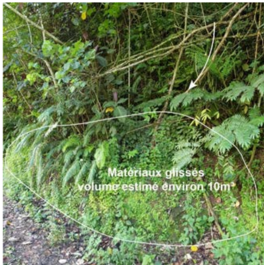
Figure 2 : Exemples de cône en pied de pente de petite taille correspondant à un glissement récent modéré de type G2 (photo associée au point GPS n° 108).
