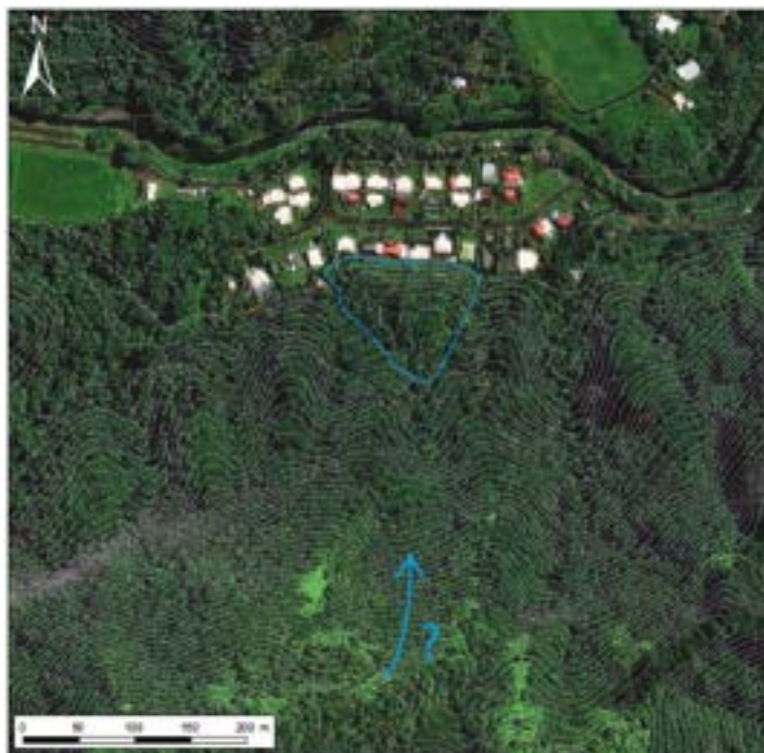
Figure 2 : Probable cône de glissement qui forme le relief à l'arrière des habitations. La partie plus en « retrait » sur le haut du versant pourrait correspondre à la zone d'arrachement.
