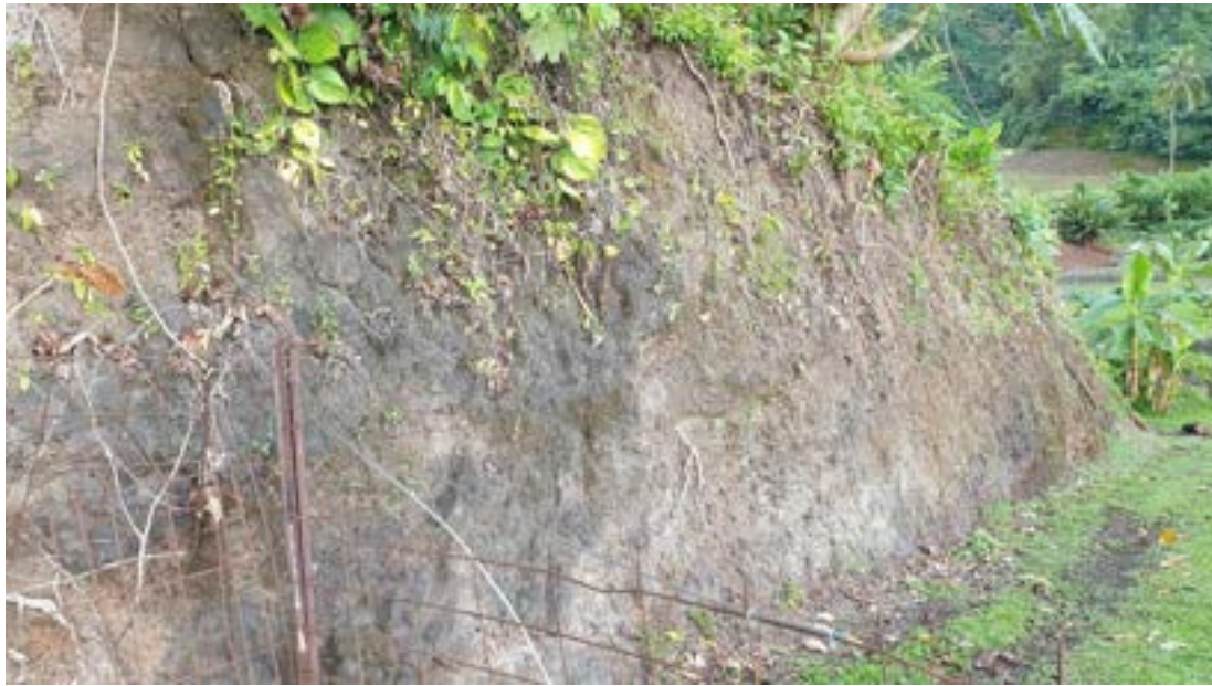
Figure 1 : Observation des formations géologiques le long de la paroi du chemin. Altération du basalte évalué comme étant à un stade de mamu de type II à localement III (photo associée au point GPS n°157).
