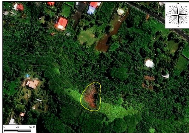
Figure 61 : Glissement de terrain identifié à partir de l'orthophotographie de 2020 – Afaahiti – PK4
