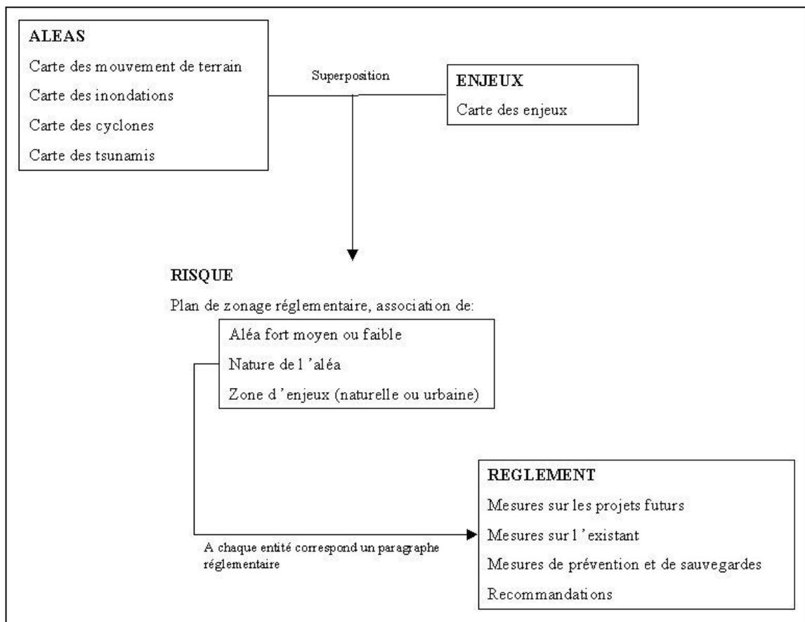
Figure 5 : schéma de principe de réalisation d'un PPR
