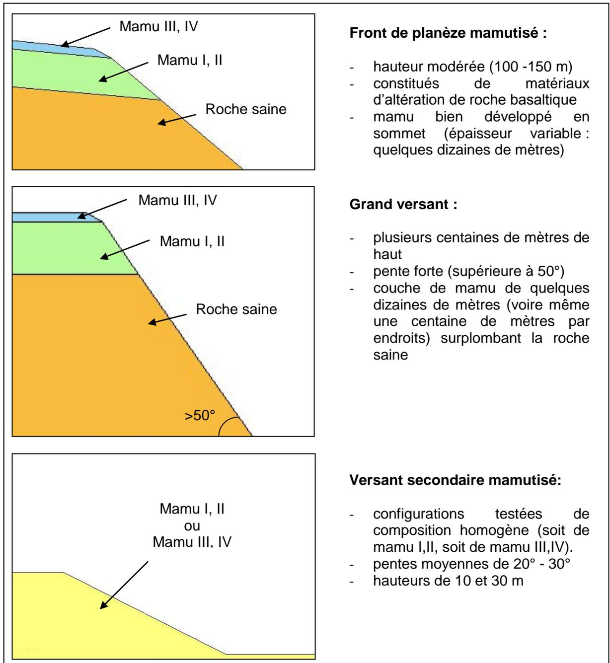
Figure 2 : Configurations types testées avec le logiciel TALREN
