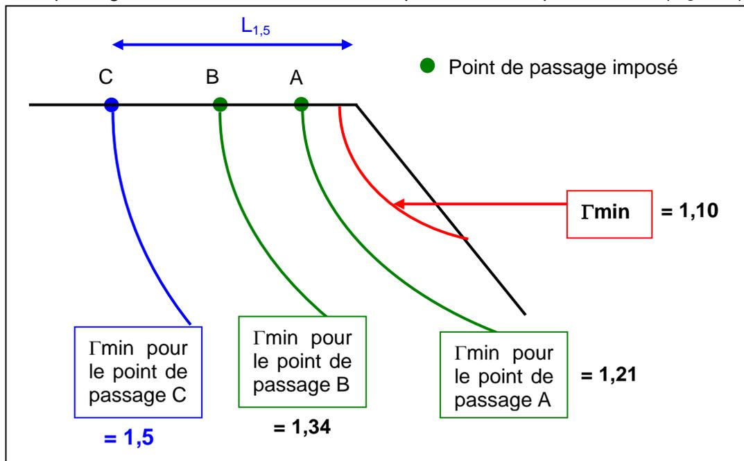
Figure 3 : Détermination de la largeur de bande de retrait minimale  $L_{1,5}$
