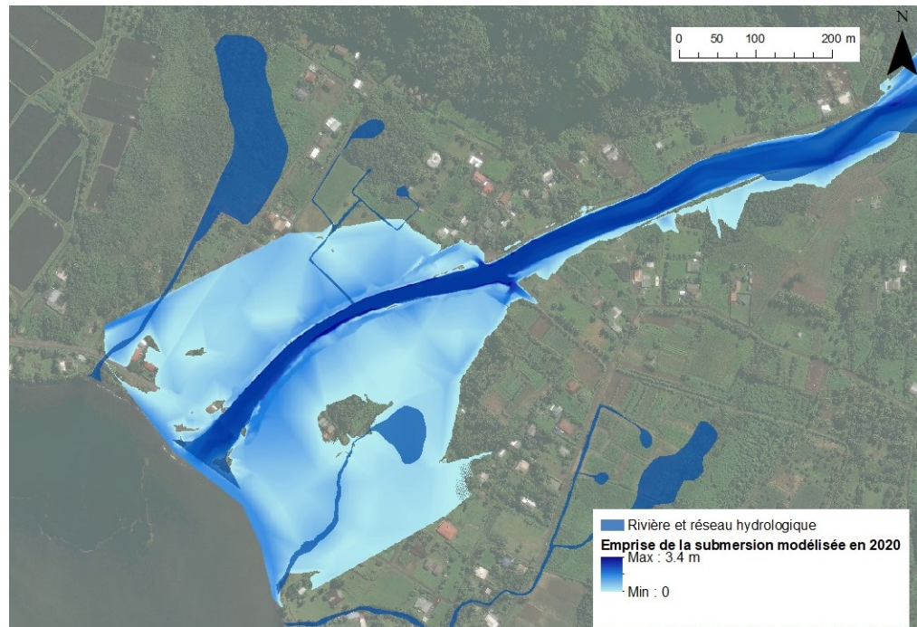
Figure 40 : Résultat de la simulation d'une crue centennale à partir de la modélisation de 2020.
