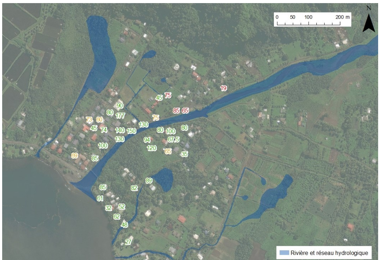
Figure 33 : Hauteurs d'eau relevées après la crue du 1er mai.
