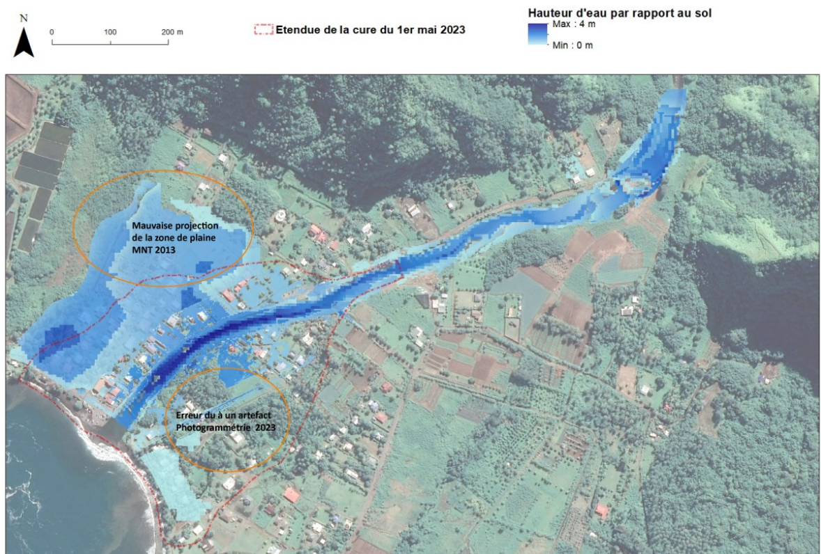
Figure 55 : Hauteurs d'eau maximum projetées par le modèle après simulation de la crue du 1er mai 2023.
