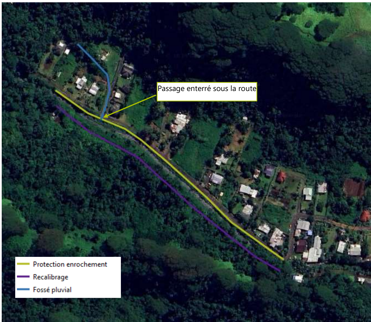
FIGURE 47 : IMPLANTATION DES AMENAGEMENTS EN AMONT
