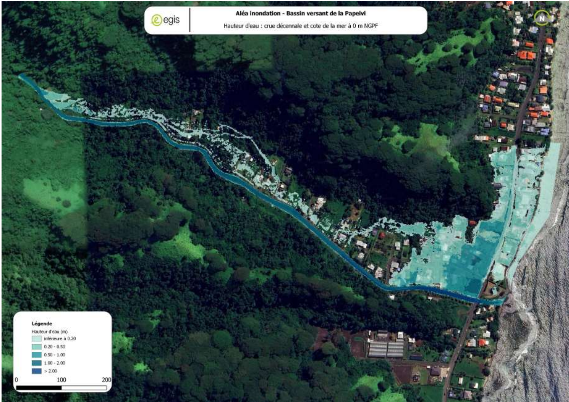
CARTOGRAPHIE DE L'ALEA INONDATION DE RIVIERES DE TAHITI VIA LE LIDAR DANS LE CADRE DES ATLAS DES RISQUES NATURELS DE POLYNESIE FRANCAISE
