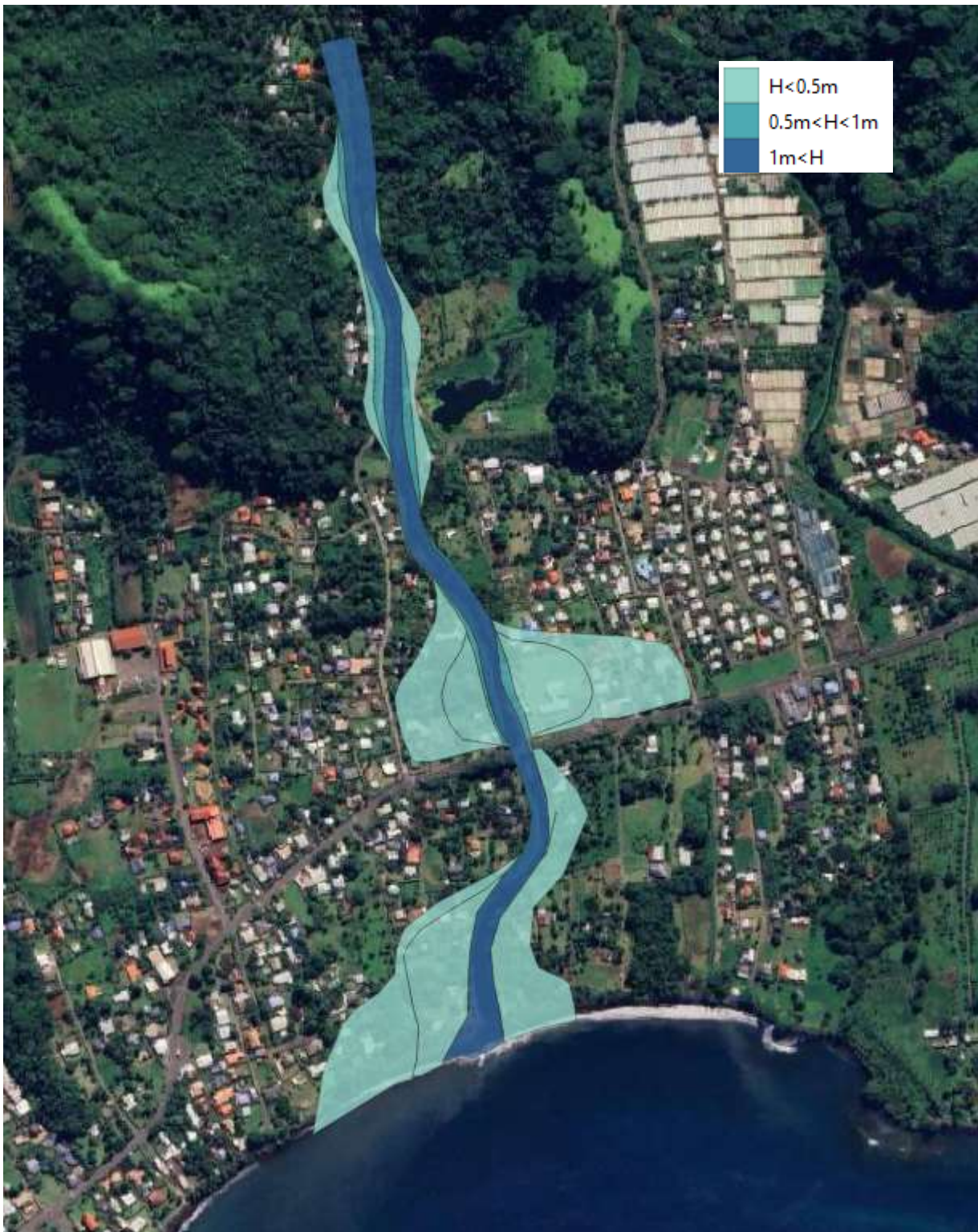
FIGURE 45 : HAUTEUR D'EAU CALCULEE DANS L'ETUDE DE 2010 POUR LA DECENNALE
