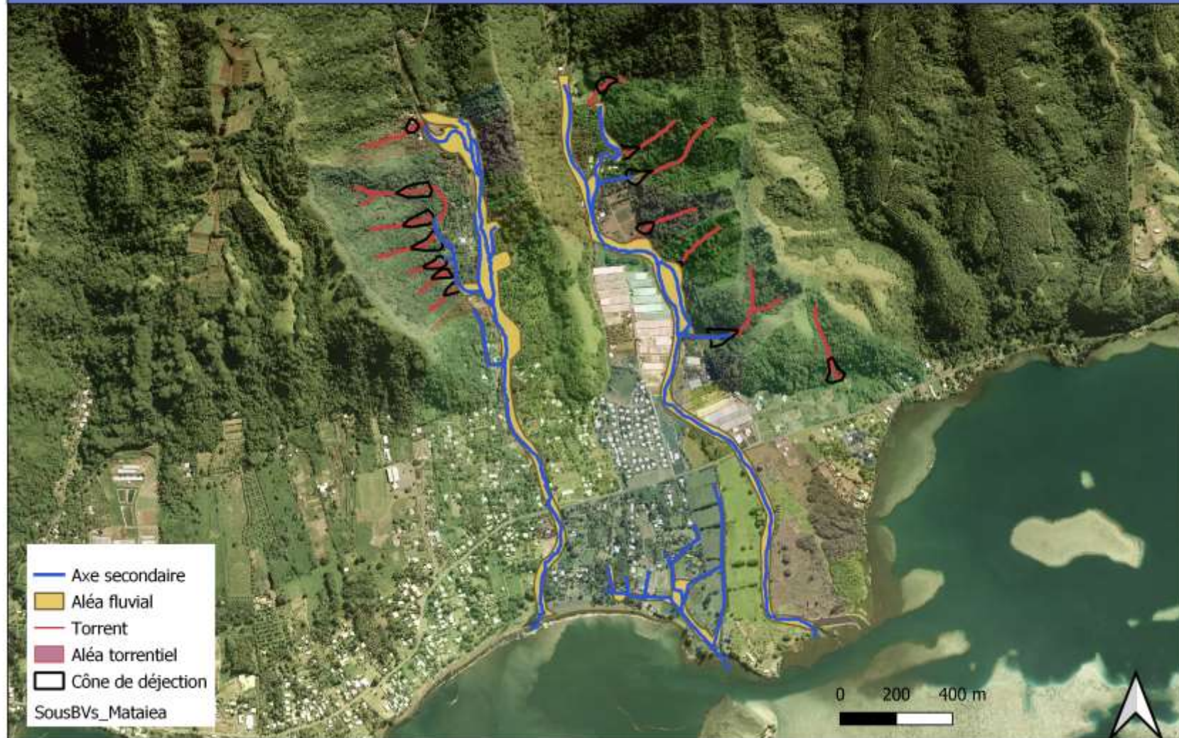
FIGURE 19. ALEAS FLUVIAUX ET TORRENTIELS DE LA VAHIRIA ET LA VAIRAHARAHA DANS LA PLAINE ALLUVIALE AVAL
