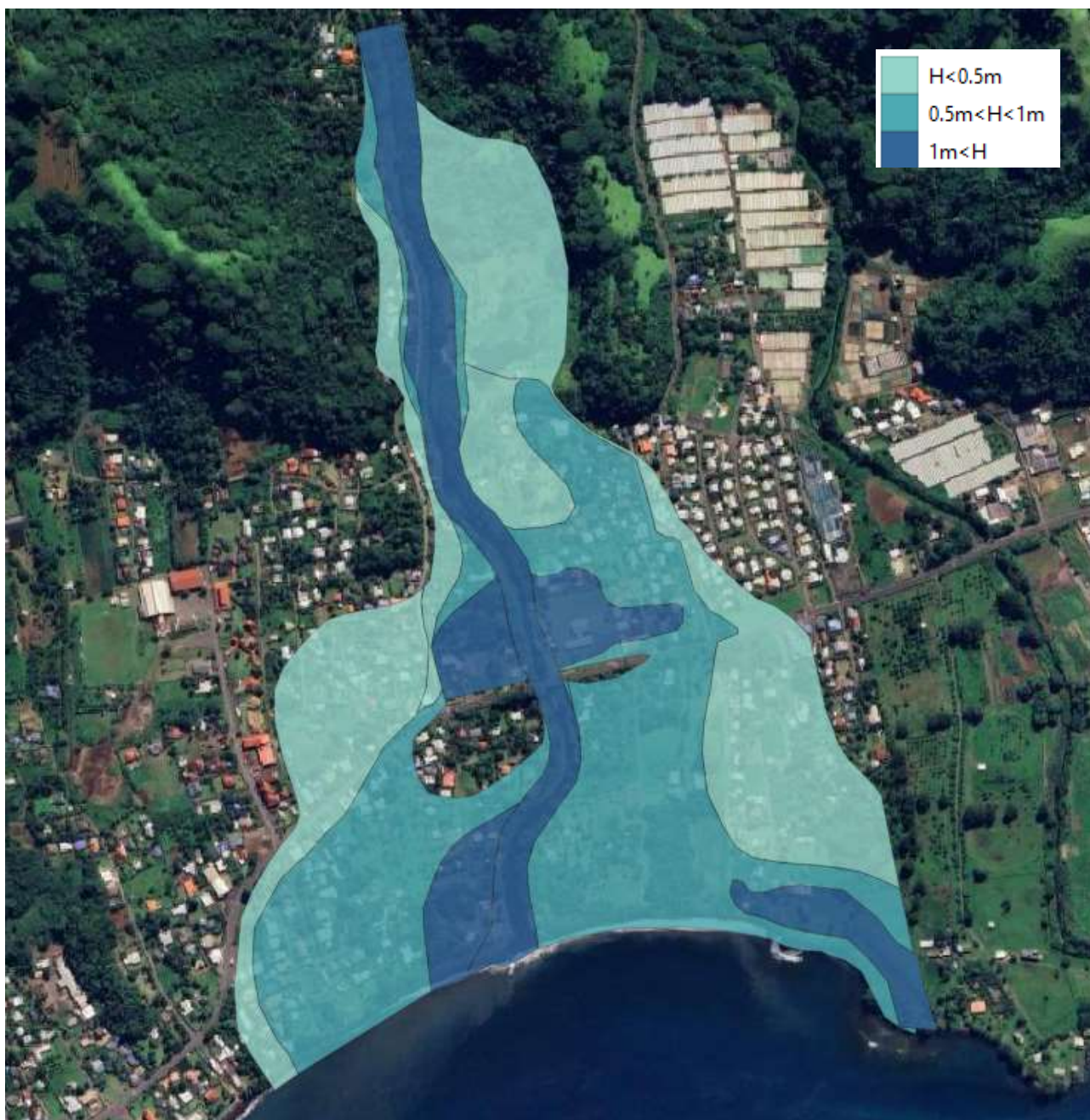
FIGURE 44 : HAUTEUR CALCULEE DANS L'ETUDE DE 2010 POUR LA CENTENNALE
