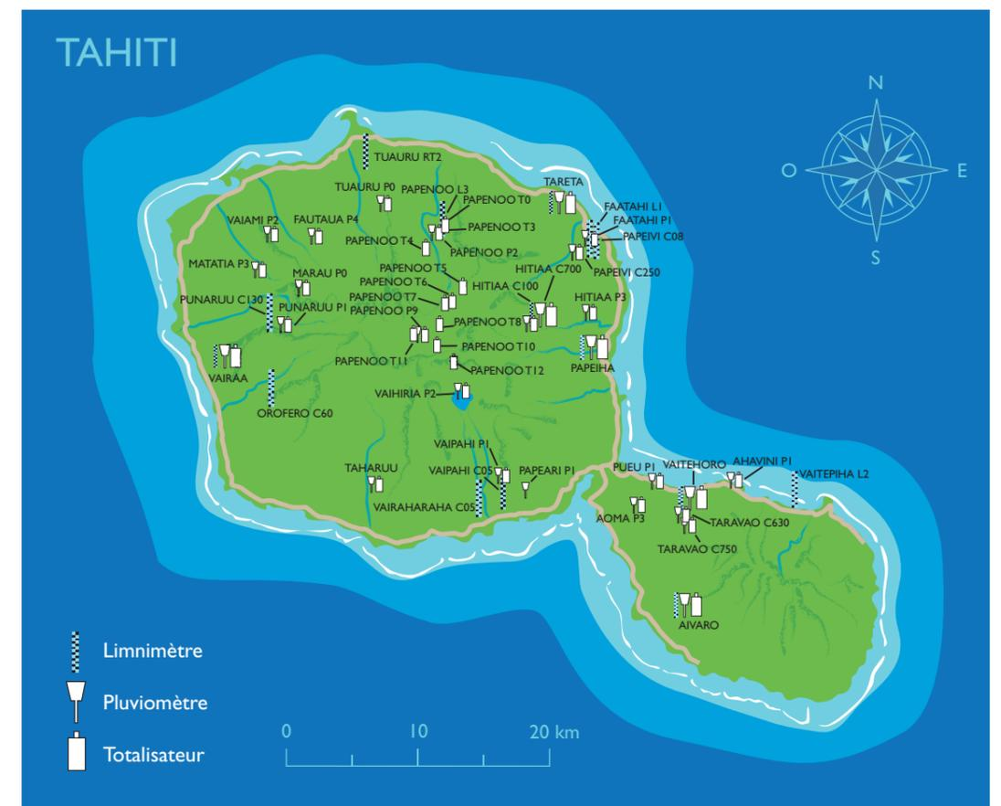
Les équipements du réseau territorial d'observations hydrologiques de Tahiti (Limnimètres, pluviomètres et totalisateurs)
