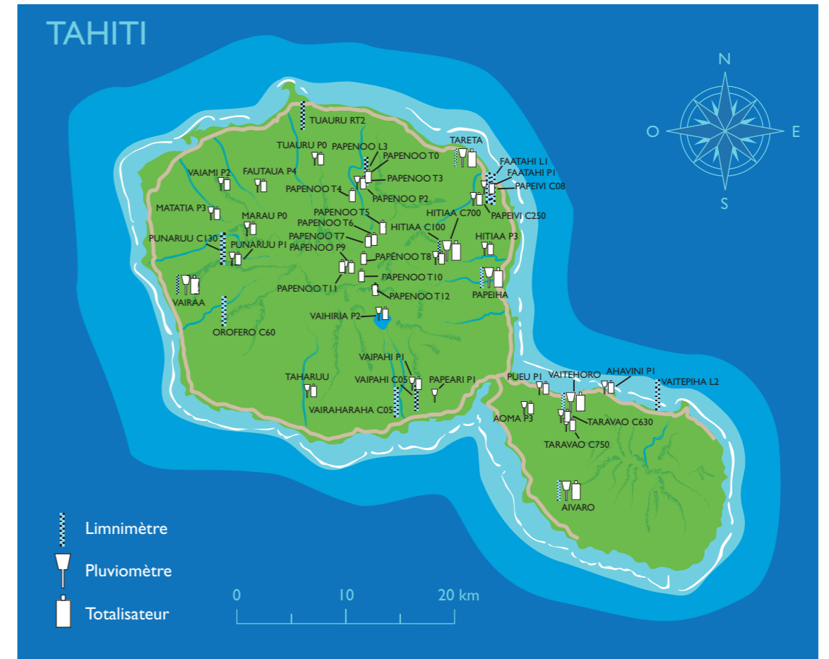
Les équipements du réseau territorial d'observations hydrologiques de Tahiti (Limnimètres, pluviomètres et totalisateurs) - Source : GEGDP 2013
