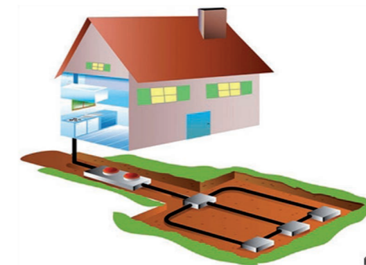
Schématisme de l'assainissement autonome individuel
