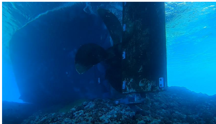
Fig 7 : extrait vidéo sous-marine hélice et safran posés sur le récif
