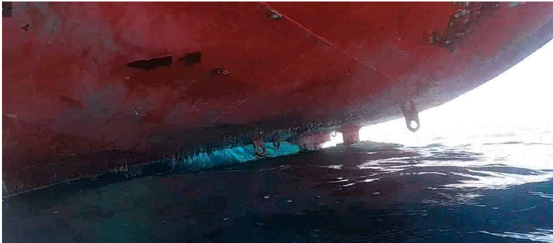
Fig 14 : Ecoulements « huileux » sur la coque arrière (extraits vidéos)
