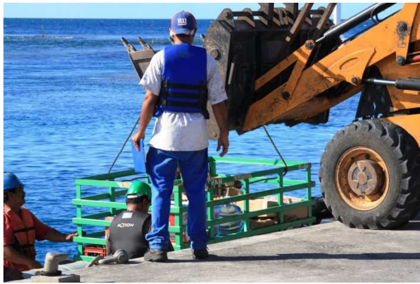
Katiu : opération de déchargement (voir distance de la roue de l'engin du quai)
