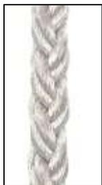
Le terme ligne de surface désigne le tronçon reliant la bouée subsurface positionnée à -5,00m à la bouée de mouillage à la surface. Elle sera également réalisée en polyamide Ø 30 mm à 8 torons.
