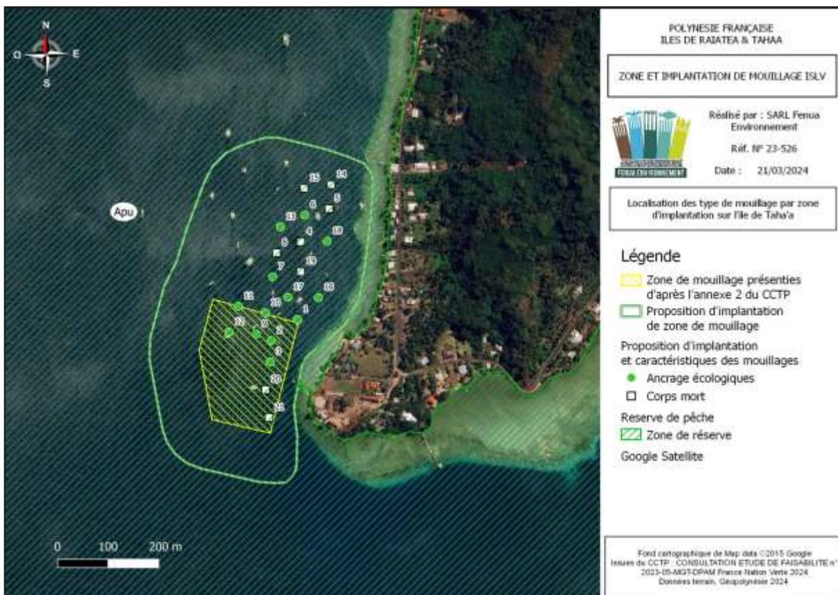
Figure 3 : exemple d'un plan de mouillage (source : Fenua environnement)
