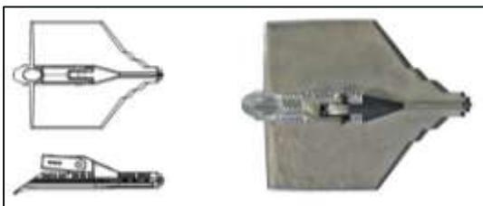
Figure 4 : exemple d'ancre à déploiement
