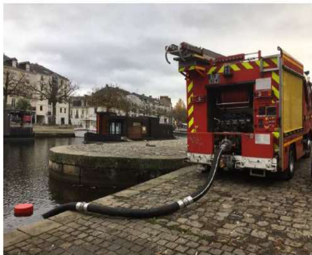
Mise en aspiration directe d'un FPT à l'aide de tuyaux d'aspiration
