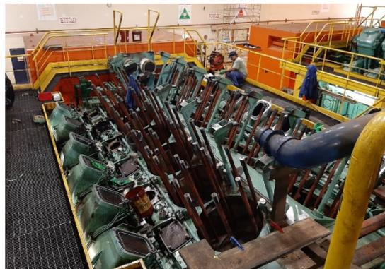
second technicien du constructeur MAN est venu pour usiner le bâti moteur et installer une pièce intermédiaire.
