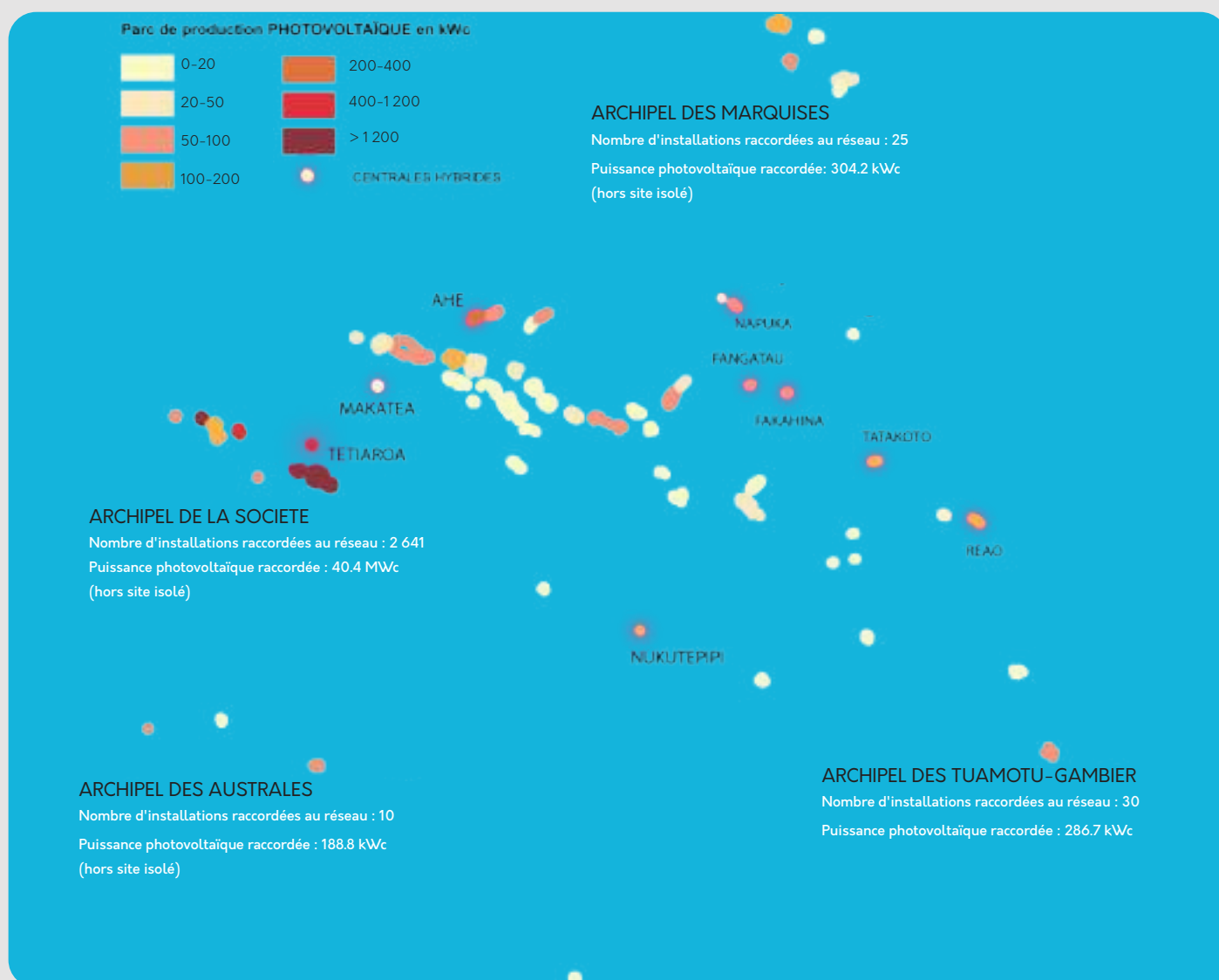
Figure 18 - Parc de production photovoltaïque en Polynésie française en 2020
