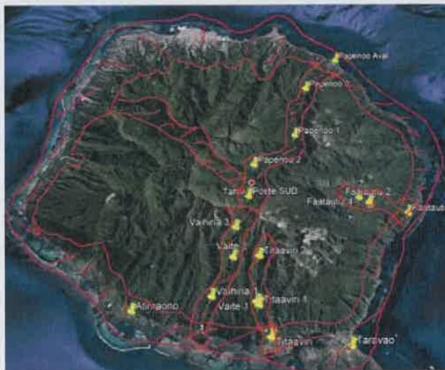
Couverture du futur réseau radiocommunication TEP
