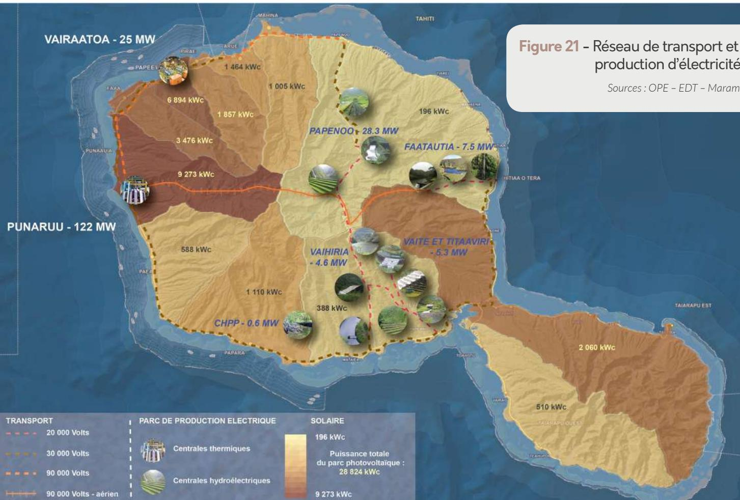
Figure 21 - Réseau de transport et parc de production d'électricité à Tahiti
