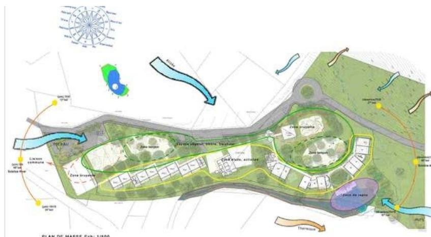
Pour optimiser la ventilation naturelle, les classes ont été orientées de manière à capter les alizées. De plus, la mise en place de larges menuiseries de type jalousies de part et d'autre des salles, ainsi que la création d'écopes en toiture permettent au flux d'air capté de balayer le local. En complément, des brasseurs d'air permettent d'assurer le contrôle du flux d'air sur les usagers.
