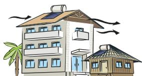
Si une toiture-terrasse est couverte d'une sur-toiture très ventilée (ratio de ventilation supérieur à 20%), aucune isolation complémentaire n'est nécessaire.
