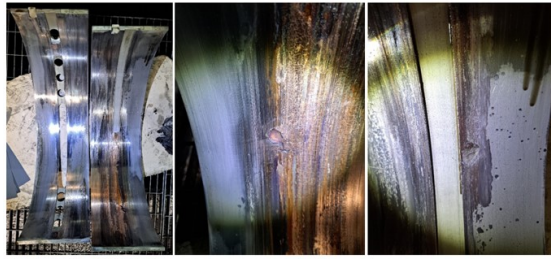
Dépose et remplacement coussinet B1
