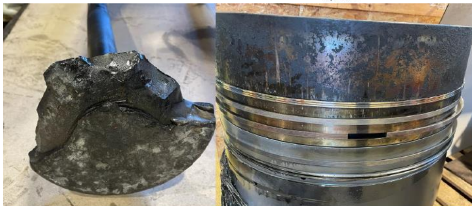
Clapet droit échappement B3 cassé
