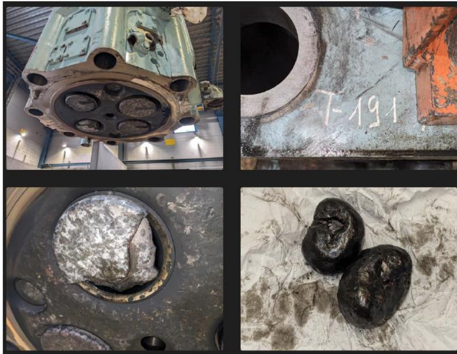
Ciel de culasse B3 endommagé
