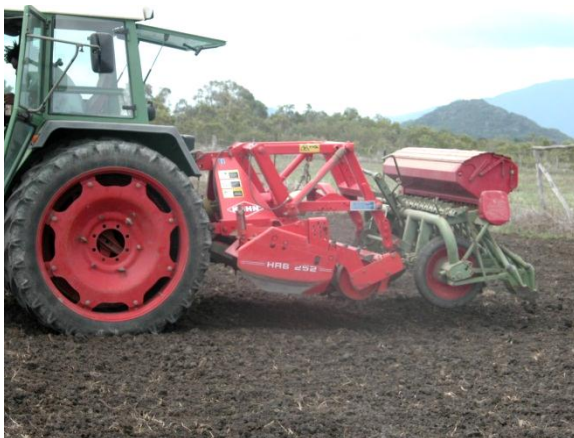
Travail en combiné avec un semoir à céréales.
