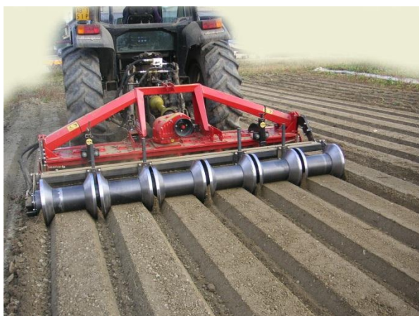
Profilage en butte à l'aide de rouleaux.
