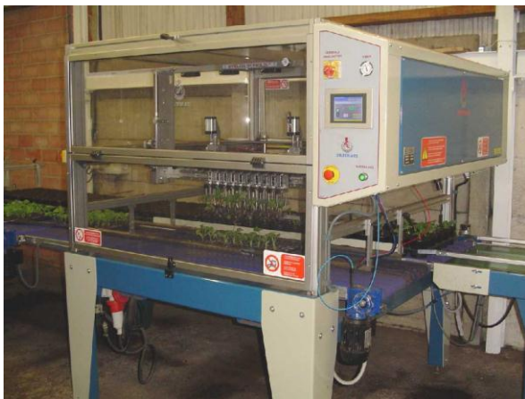
Machine à préparer les plants en mottes.
