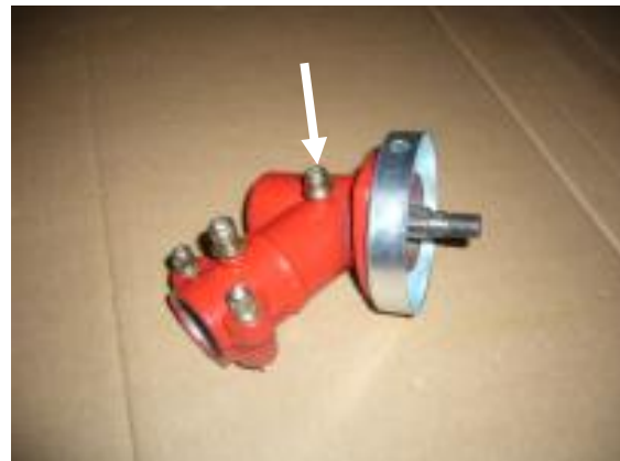
Bouchon vissé pour la lubrification.
