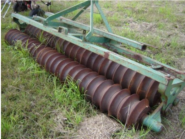
Les rouleaux doubles à diamètres différents sont totalement déconseillés car très sensibles aux bourrages en sol meuble.
