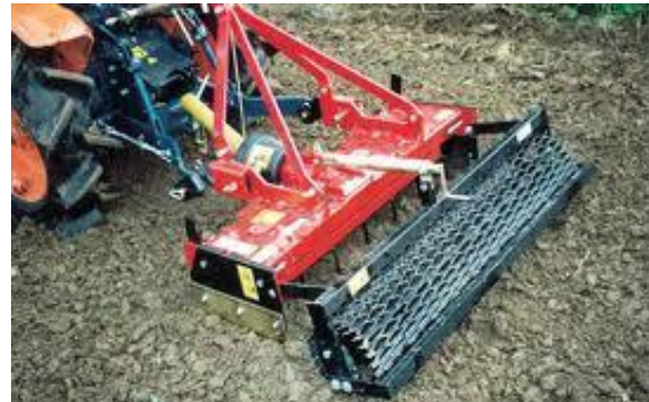
Rouleau du type "cage" associé à une herse rotative.
