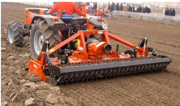
Rouleau du type "packer" associé à une herse rotative.
