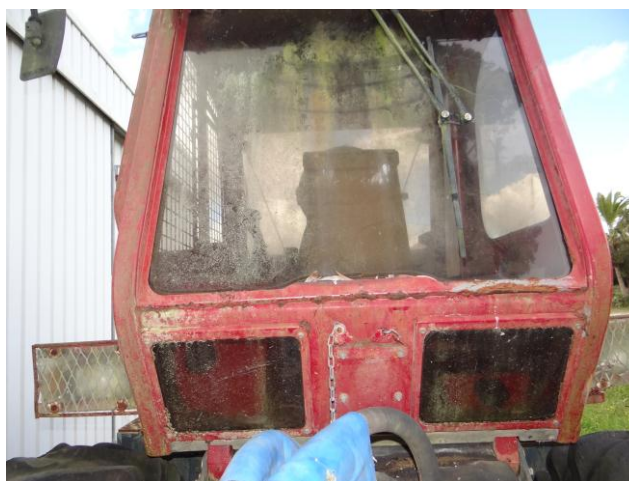
Cabine dans un état de dégradation avancé
