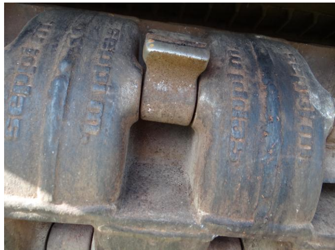
Niveau d'usure des marteaux.
