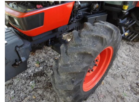
Usure avancée des pneumatiques avant.
