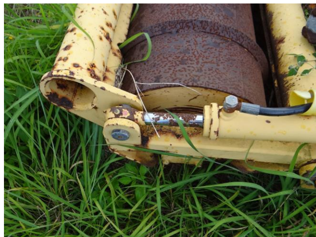
Détail de l'ampleur de corrosion sur les vannes.
