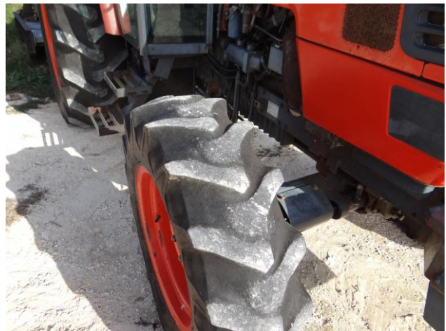
Taux d'usure courant sur les ponts avant.
