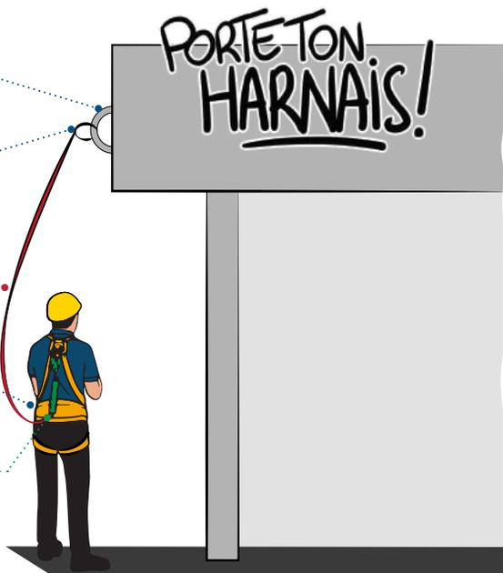
La qualité de l'équipement est importante car **la chute de hauteur peut entraîner un risque mortel**. Lorsque la protection d'un travailleur ne peut être assurée qu'au moyen d'une ceinture, d'un baudrier ou d'un harnais de sécurité, jamais ce travailleur ne demeure seul.
