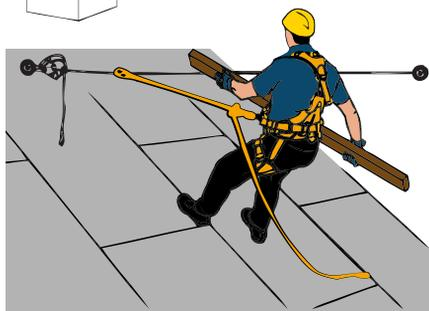
Il est constitué d'un harnais ou d'une ceinture, relié à un point d'ancrage par une longe de positionnement. Le dispositif de préhension du corps à privilégier défini par la norme NF EN 363 est le harnais conforme à la norme NF EN 361.
