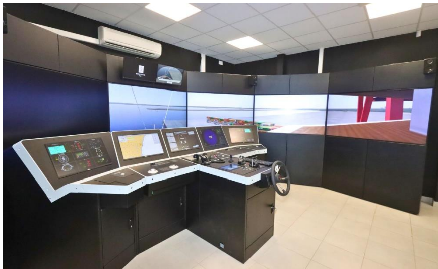
Figure 7: Le nouveau simulateur de navigation du CMMPF
